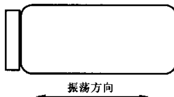
图 3 塑料广口瓶的振荡方向
