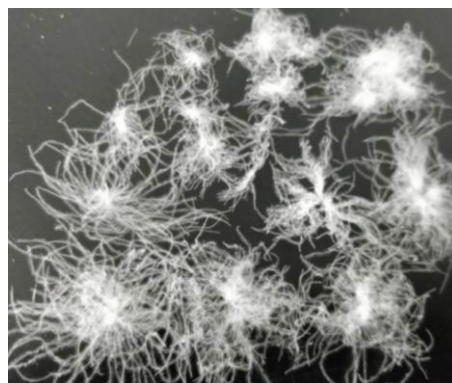
图 A.1.2 胶水羽绒 颗粒附着，粘结成块
