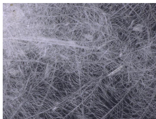
图 B.1.3 胶水羽绒：明显不规则胶状物
