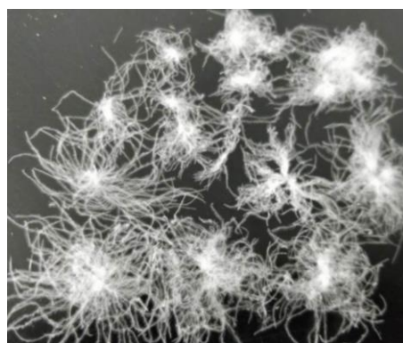
图 A.1.2 胶水羽绒 颗粒附着，粘结成块
