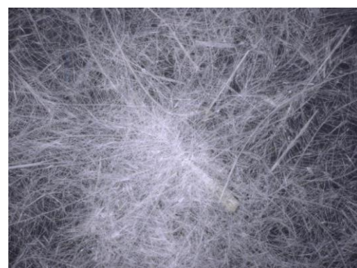
图 B.1.5 胶水羽绒：绒核不清晰且有反光物质
