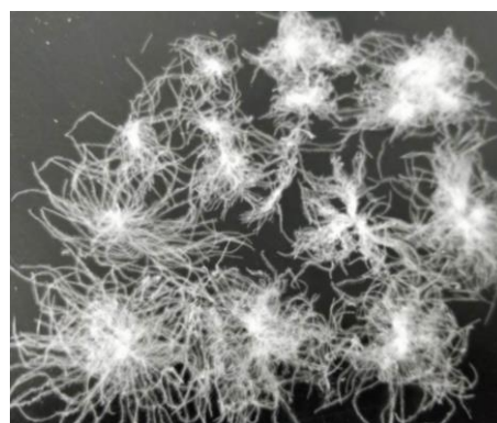
图 A.1.2 胶水羽绒 颗粒附着，粘结成块
