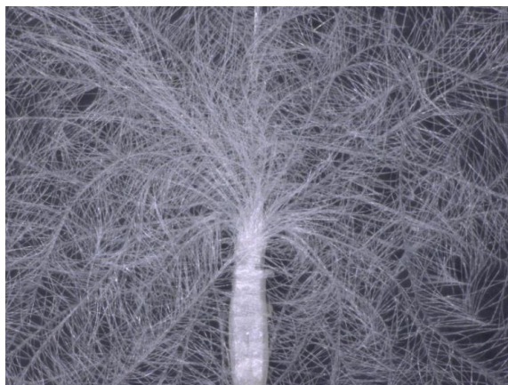
图 B.1.1 正常羽绒：绒核清晰且放射出许多绒丝形成朵状
