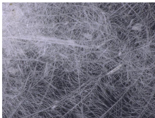
图 B.1.3 胶水羽绒：明显不规则胶状物
